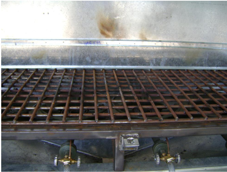
ภาพที่ 3.10 ลักษณะภายในของเตาเผาชาห่มูต้นแบบ
