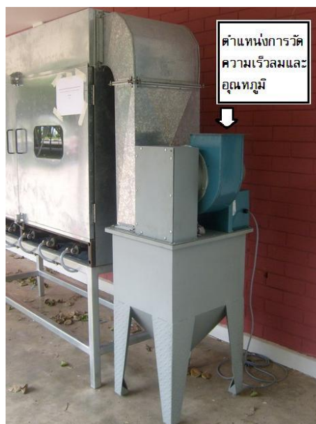
ภาพที่ 4.2 ตำแหน่งการวัดความเร็วลมและอุณหภูมิด้านขาออกของเตา
