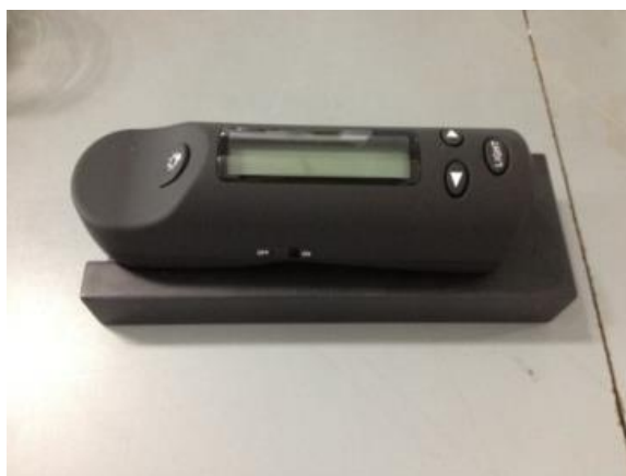
ภาพผนวก ก1 เครื่องวัดค่าสี (Handy colorimeter NR-3000, Japan)
