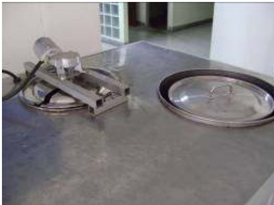
ภาพที่ 3.3 ถังเขี่ยก้างและถังปั่น เดิม (ซ้าย) ปรับใหม่ (ขวา)
