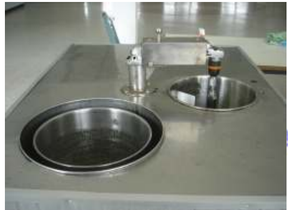
ภาพที่ 3.3 ถังเขี่ยก้างและถังปั่น เดิม (ซ้าย) ปรับใหม่ (ขวา)
