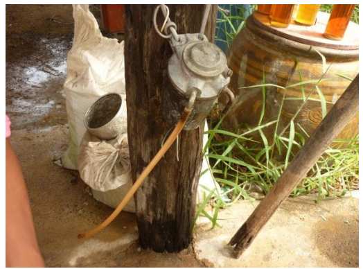
4. ผสมน้ำมันที่กรองด้วยผ้าขาวบาง 10 ลิตร กับน้ำมันดีเซล 2 ลิตร แล้วกรองด้วยเครื่องกรองไบโอดีเซล
