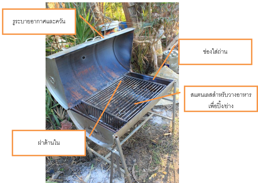
ภาพที่ ค.18 ด้านในของเตาย่างไถ้ ชุมชนบ้านคลอง 10 ตัน ตำบลสนับทึบ
