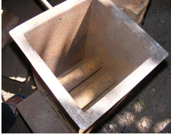
ภาพที่ ง.19 ตัวอย่างของถังใส่น้ำเพื่อหนึ่งใบเมียง ภายในเตาหนึ่งเมียงประสิทธิภาพสูง
