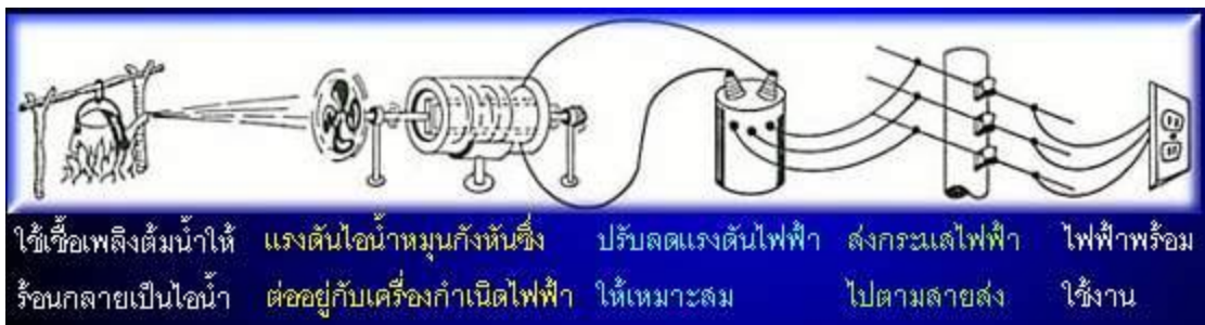
ภาพที่ 2.30 กระบวนการผลิตไฟฟ้าในโรงไฟฟ้าพลังงานนิวเคลียร์
