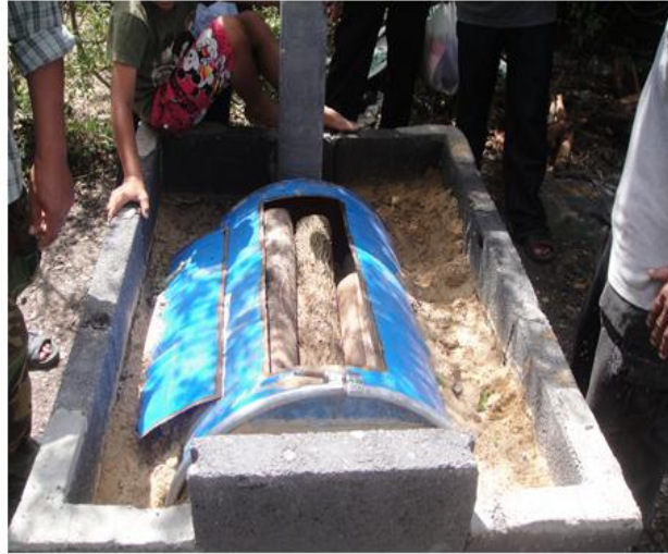
ภาพที่ 2.15 เตาเผาถ่านไม้ขนาด 200 ลิตร แบบนอน
