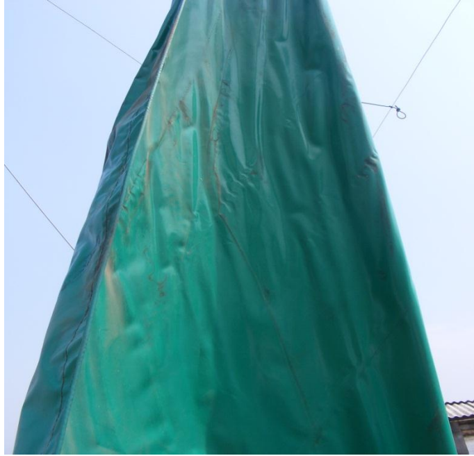
ภาพที่ ง.11 ใบบัดของกังหันที่ทำจากผ้าเต็นท์เมื่อกางออกเพื่อตากลม
