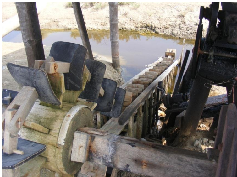
ภาพที่ ง.12 ระหัดวิดน้ำสำหรับประกอบเข้ากับกังหันลมเพื่อวิดน้ำเข้านาเกลือ
