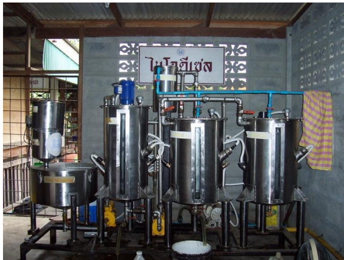
ภาพที่ 2.29 เครื่องผลิตไบโอดีเซล ของชุมชนคอยูกตักวา เขตหนองจอก กรุงเทพมหานคร
