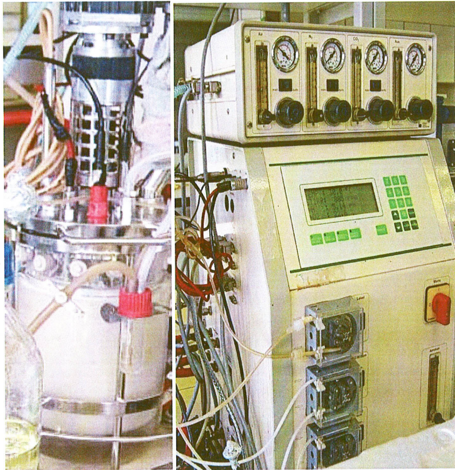
ภาพที่ 62 การหมักผลผลิตทางการเกษตรที่มีแป้งเป็นองค์ประกอบหลักในถังปฏิกรณ์ 5 ลิตร
