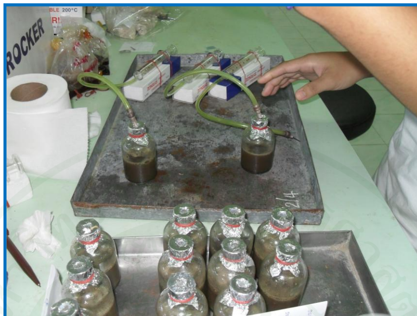
ภาพผนวกที่ 6 วิธีวัดปริมาณผลผลิตแก๊สในขวดซีรัม
