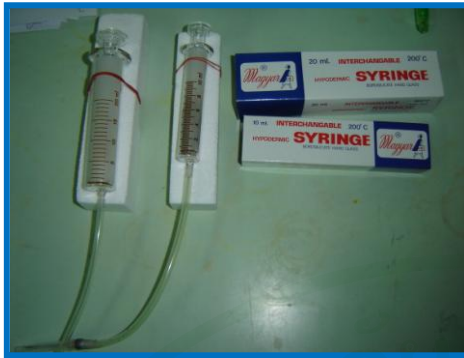
ภาพผนวกที่ 1 ไซลิงค์และขวดซีรัม ที่ใช้ในการวัดปริมาณแก๊ส
