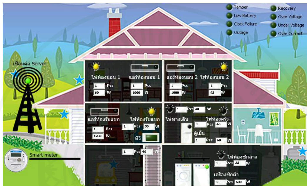
ภาพที่ 11 โปรแกรม LabView จำลองการทำงานของเครื่องใช้ไฟฟ้าภายในบ้านและมิเตอร์อัจฉริยะ
