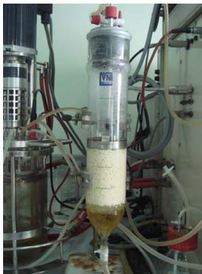
ภาพที่ 8 ถังปฏิกรณ์เซลล์ตรึงแพ็คเกจ ขนาดเส้นผ่านศูนย์กลาง และส่วนสูงเท่ากับ 6.6x27.5 เซนติเมตร
