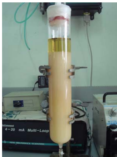
ภาพที่ 11 คอลัมน์แลกเปลี่ยนประจุ (Ion exchange colum) ขนาดเส้นผ่านศูนย์กลาง และส่วนสูง เท่ากับ 4.6 x 20 เซนติเมตร(ภาคผนวก ข: ข้อมูลและรายละเอียดคอลัมน์แลกเปลี่ยน ประจุ)
