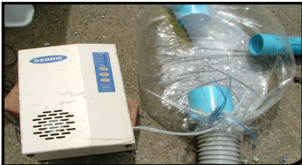
ภาพผนวกที่ 3 เครื่องผลิตก๊าซโอโซน (Ozone Generator-รุ่น Sunny, K-Link (Thailand) Co., Ltd., Thailand) และการผสมอากาศ
