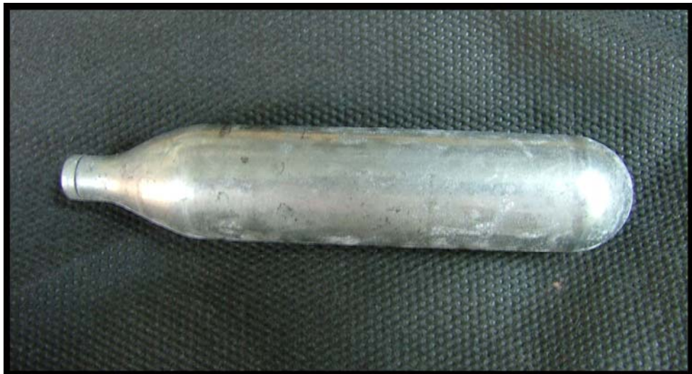
ภาพผนวกที่ 6 CO 2 tank ที่ใช้ในการกำหนดความเข้มข้นของก๊าซคาร์บอนไดออกไซด์ (CO 2 )
