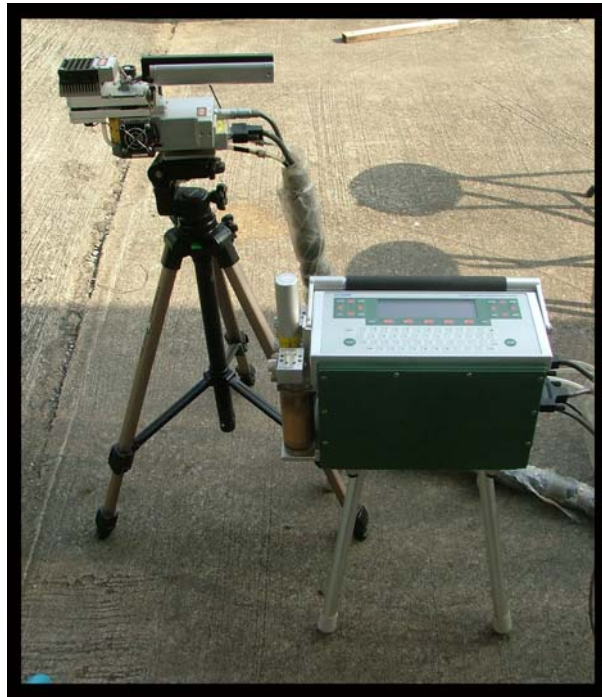
ภาพผนวกที่ 5 เครื่องมือวัดอัตราการสังเคราะห์ด้วยแสงสุทธิ (Portable Photosynthesis System รุ่น LI-6400 LI-COR, Inc., U.S.A)
