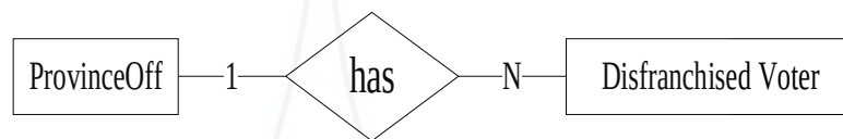
ภาพที่ 3.42 แสดงแผนภาพความสัมพันธ์ของ เอนทิตี ProvinceOff กับเอนทิตี Disfranchised Voter
