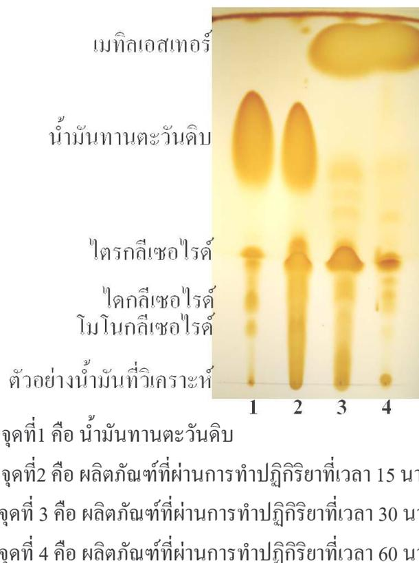
**ภาพที่ 29** ภาพแสดงผลการวิเคราะห์ผลิตภัณฑ์ที่เวลาในการทำปฏิกิริยา 15 30 และ 60 นาทีด้วยวิธีโครมาโทกราฟีแบบแผ่นเคลือบ
