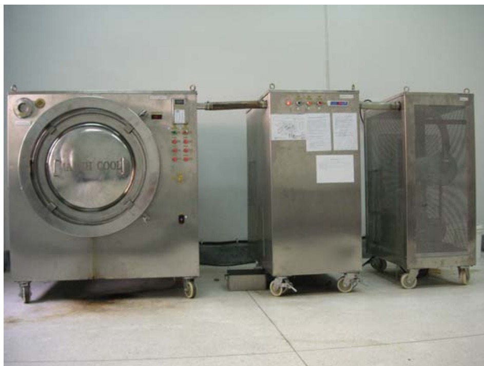
รูปที่ ผ.2.2: ตู้อบไมโครเวฟสุญญากาศ (Microwave vacuum dryer, MARCH COOL, Thailand)
