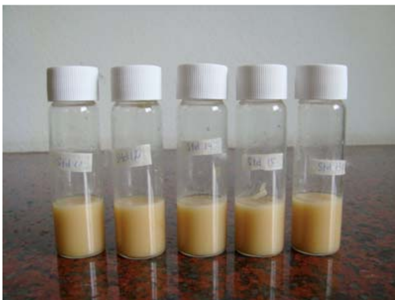
รูปที่ ผ.5.8: ข้าวโพดบดละเอียดที่ผ่านกรรมวิธีอัดไอน้ำที่อุณหภูมิ 121 องศาเซลเซียส นาน 20 นาที อัตราส่วน 3 กรัม ผสมในบัพเฟอร์ 10 มิลลิลิตร และเอนไซม์แอสเพอเรส 1500 หลังทำปฏิกิริยาที่ 40 องศาเซลเซียส ด้วยเครื่องธรมเลอร์ เป็นระยะเวลา 48 ชั่วโมง
