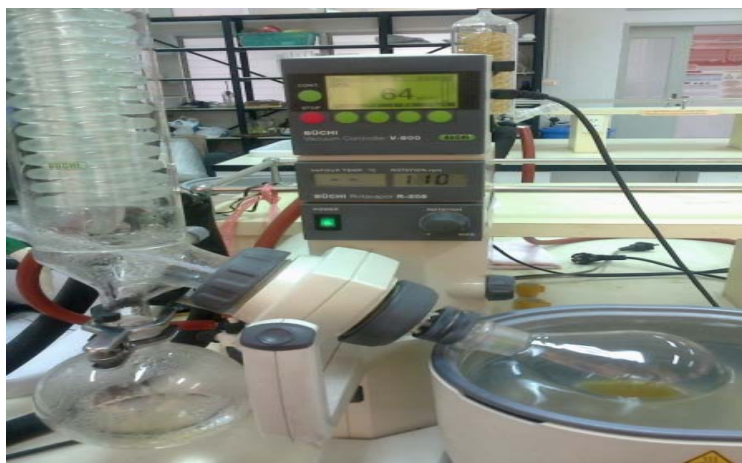
รูปที่ ผ.5.16: การทำให้เข้มข้นด้วยเครื่องระเหยแบบสุญญากาศแบบหมุน (rotary evaporator) ที่อุณหภูมิ 60 องศาเซลเซียส
