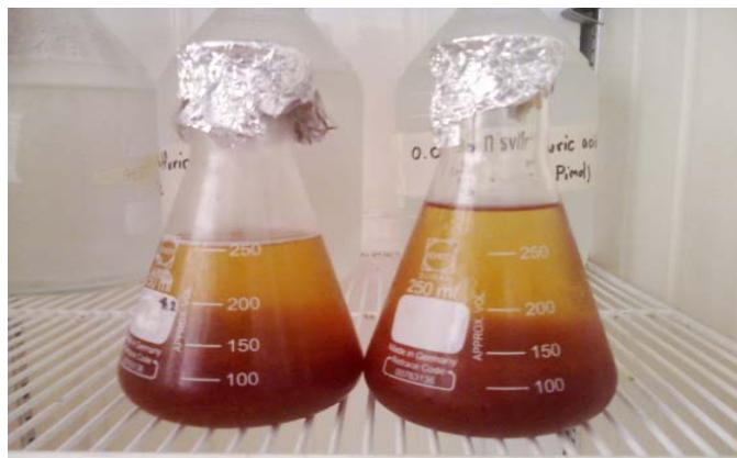
รูปที่ ผ.5.15: การลดกลั่นในน้ำเชื่อมกลูโคส-ฟรุคโตสด้วยการแช่ในเรซิน อัตราส่วน 1:1 (ของเหลว : เรซิน) นาน 3 ชั่วโมง อุณหภูมิ 4 องศาเซลเซียส
