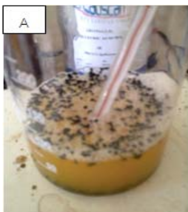
รูปที่ ผ.5.14: การเติมผงถ่าน (a) และกวน (b) นาน 20 นาที ในระหว่างให้ความร้อนที่อุณหภูมิ 60 องศาเซลเซียส เพื่อลดสีของน้ำเชื่อมกลูโคส/ฟรุคโตส
