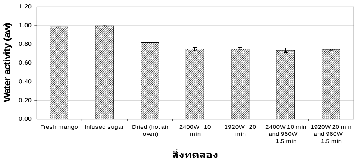
รูปที่ 4.2.9: การเปลี่ยนแปลงค่าวอเตอร์แอคทิวิตี ( a_w ) ของขึ้นมะม่วงในระหว่างกระบวนการอบแห้งด้วยตู้อบไมโครเวฟสุญญากาศ
