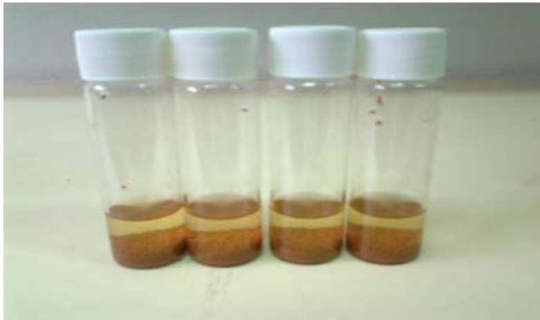
รูปที่ ผ.5.12: การทดสอบเอนไซม์กลูโคสไอโซเมอเรสในการเปลี่ยนน้ำตาลกลูโคสให้กลายเป็นน้ำตาลฟรุคโตสด้วยสารละลายมาตรฐานกลูโคส ความเข้มข้น 30 กรัมต่อลิตร ทำปฏิกิริยาที่ 40 องศาเซลเซียส เป็นระยะเวลานาน 24 และ 48 ชั่วโมง
