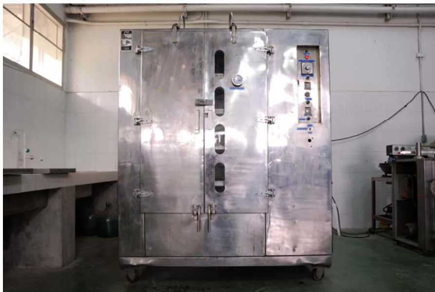
รูปที่ ผ.2.1: ตู้อบลมร้อนแบบถาด (Tray type hot air dryer, NAVALOY, Thailand)
