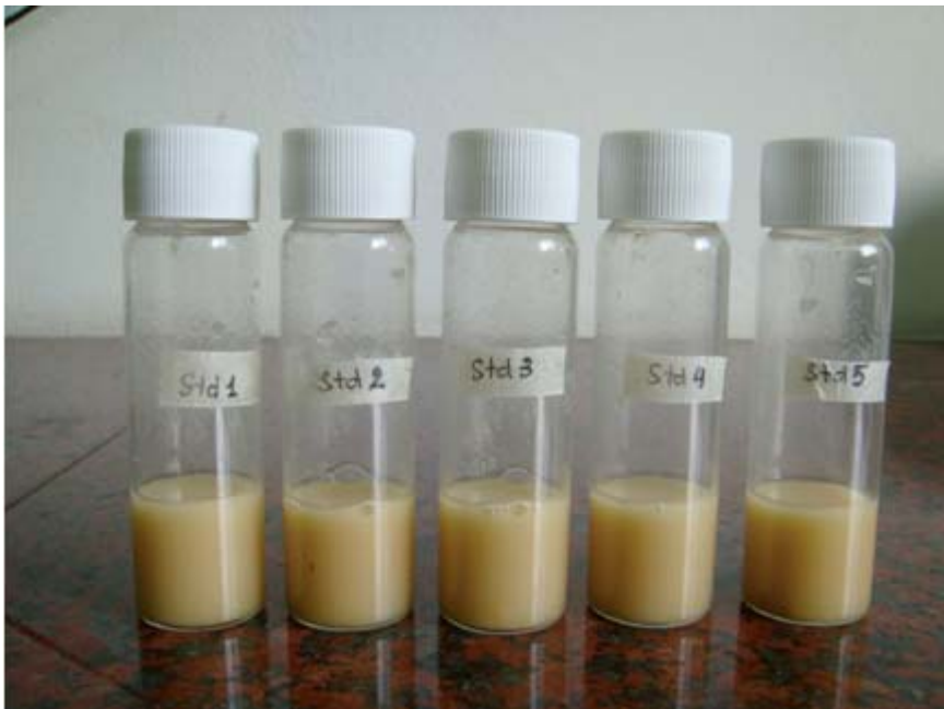
รูปที่ ผ.5.7: ข้าวโพดบดละเอียดที่ผ่านกรรมวิธีอัดไอน้ำที่อุณหภูมิ 121 องศาเซลเซียส นาน 20 นาที อัตราส่วน 3 กรัม ผสมในบัฟเฟอร์ 10 มิลลิลิตร และเอนไซม์แอสเพอเรส 1500 หลังทำปฏิกิริยาที่ 40 องศาเซลเซียส ด้วยเครื่องร้อมเลอร์ เป็นระยะเวลา 24 ชั่วโมง
