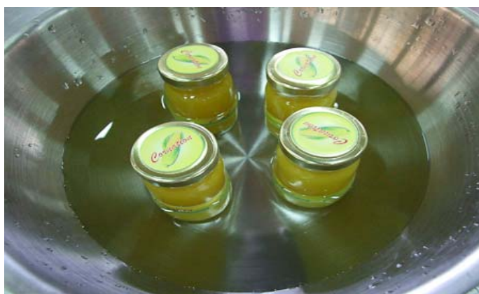
รูปที่ ผ.4.11: การทำให้เย็นหลังบรรจุขณะร้อน
