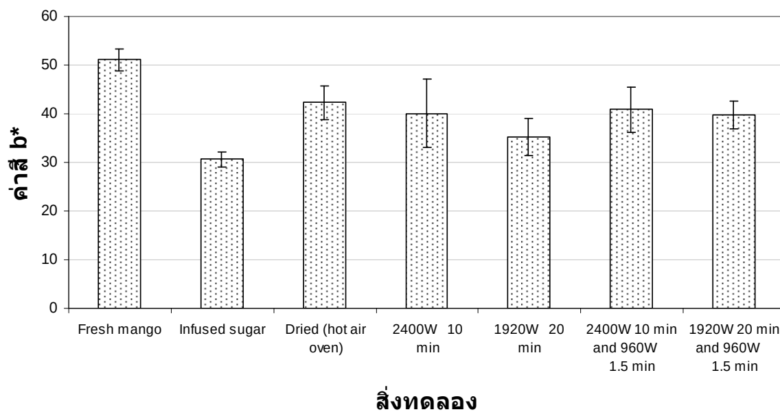
รูปที่ 4.2.13: การเปลี่ยนแปลงค่าสี b* ของชิ้นมะม่วงในระหว่างกระบวนการอบแห้งด้วยตู้อบไมโครเวฟ สุญญากาศ
