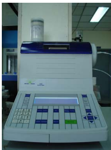
ภาพผนวกที่ ข1 เครื่องวัดความหนาแน่นรุ่น Toledo DE40 จากบริษัท Mettler
