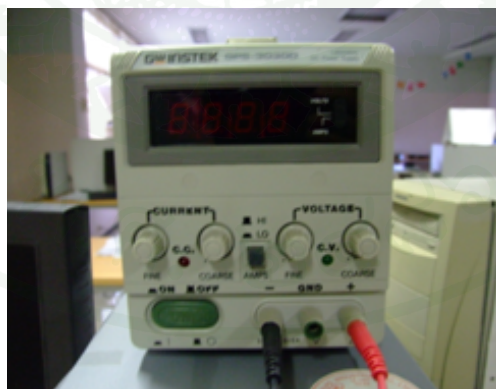
ภาพที่ 17 แหล่งจ่ายไฟฟ้าสำหรับมอเตอร์กระแสตรง
