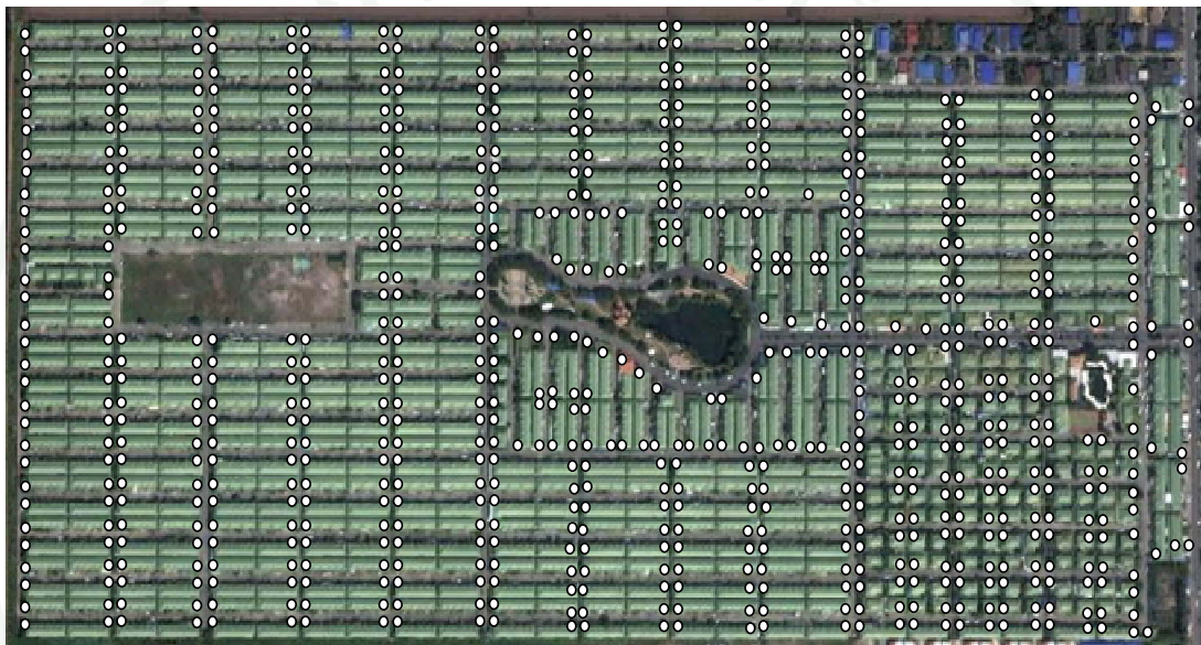
ภาพที่ 22 แบบจำลองพื้นที่หมู่บ้านและตำแหน่งมิเตอร์ทั้งหมด โดยสมมติให้สมาร์ตมิเตอร์ติดตั้งในแนวถนนเดียวกัน หมู่บ้านกฤษดานนคร อำเภอคลองหลวง จังหวัดปทุมธานี ขนาดพื้นที่โดยประมาณ 500 เมตร ) \times 1000 เมตร มิเตอร์จำนวน 800 ชุด
