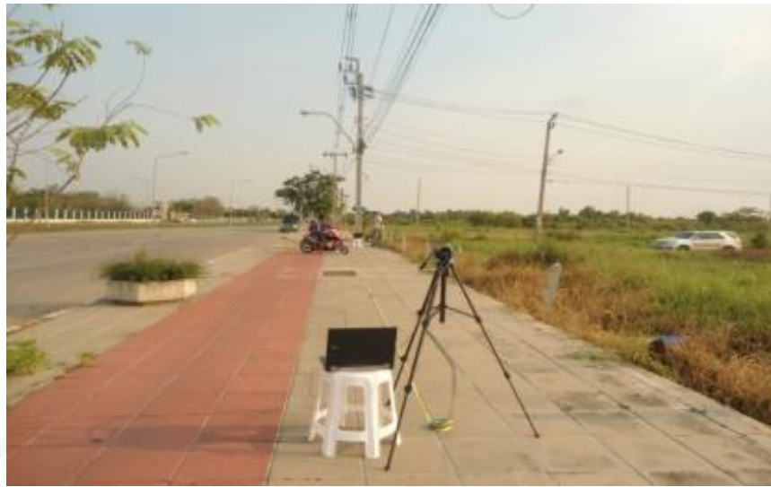
ภาพที่ 18 สภาพแวดล้อมแบบที่ 3 สมาร์ทมิเตอร์ถูกติดตั้งบนเสาไฟฟ้า ความสูง 1-2 เมตรจากระดับพื้นดิน ตามแนวถนนหลัก ขนาด 6-8 ช่องจราจรนอกชุมชน การกำหนดการติดตั้งแบบนี้เป็นการจำลองการส่งสัญญาณคลื่นวิทยุระหว่างสมาร์ทมิเตอร์ ไปยัง โครงข่ายสื่อสารหลักของ กฟภ.
