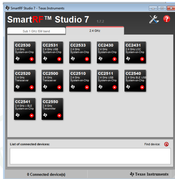
ภาพที่ 11 การเริ่มใช้งานโปรแกรม SmartRF Studio7 เมื่อต่อสาย USB Port เชื่อมระหว่างบอร์ดชิกปีและคอมพิวเตอร์ โปรแกรมจะตรวจจับสัญญาณจากบอร์ดทดลองได้อัตโนมัติ
