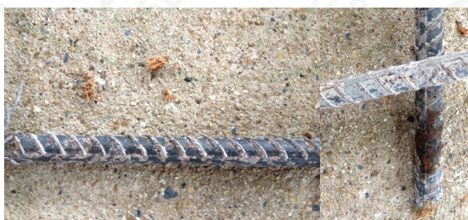
ภาพที่ 68 สนิมในเหล็กเสริมของตัวอย่างที่มีค่าศักย์ไฟฟ้าสูงกว่า -350 มิลลิโวลต์ทั้งในสภาพแห้งและเปียก
