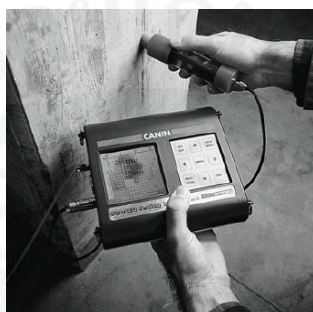
ภาพที่ 6 การตรวจสอบโดยวิธีศักย์ไฟฟ้าครึ่งเซลล์ (Half-Cell Potential Measurement)
