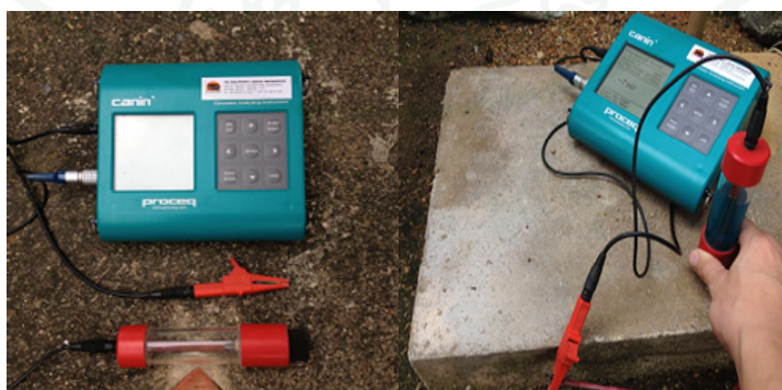
ภาพที่ 18 เครื่องมือการวัดค่าศักย์ไฟฟ้า (ซ้าย) และการวัดค่าศักย์ไฟฟ้าครึ่งเซลล์ (ขวา)
