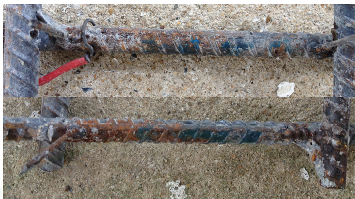
ภาพที่ 69 สนิมในเหล็กเสริมของตัวอย่างที่มีค่าศักย์ไฟฟ้าในสภาพแห้งสูงกว่า -350 มิลลิโวลต์ แต่ค่าศักย์ไฟฟ้าในสภาพเปียกต่ำกว่า -350 มิลลิโวลต์
