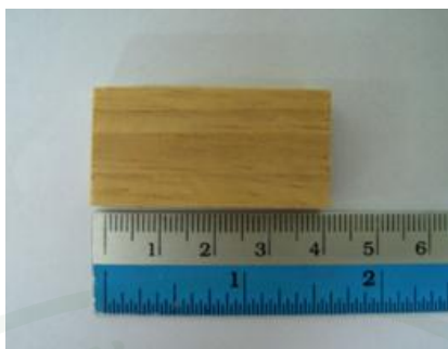
ภาพที่ 17 แสดงแผ่นไม้ยางพารา ขนาด 20 \times 40 \times 8 \text{ mm}^3
