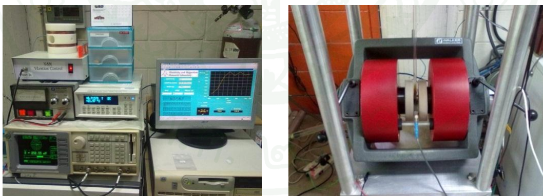
ภาพที่ 21 แสดงเครื่องแมกนีโตมิเตอร์แบบสั่นตัวอย่าง (VSM)
