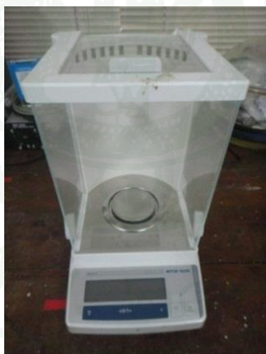
ภาพที่ 18 แสดงเครื่องชั่งละเอียดทศนิยม 4 ตำแหน่ง
