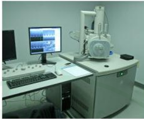
ภาพที่ 24 แสดงกล้องจุลทรรศน์อิเล็กตรอนแบบส่องกราด (SEM)
