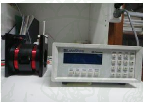
ภาพที่ 35 แสดงการต่อขดลวดเฮล์มโฮลต์กับปลั๊กซ์มิเตอร์
