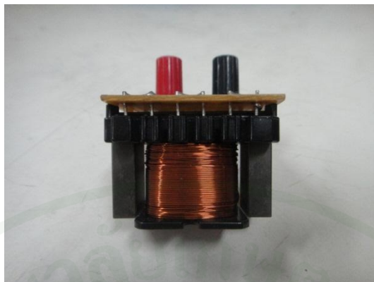
ภาพที่ 29 แสดงขดลวดโซเลนอยด์ที่ใช้สร้างสนามแม่เหล็ก
