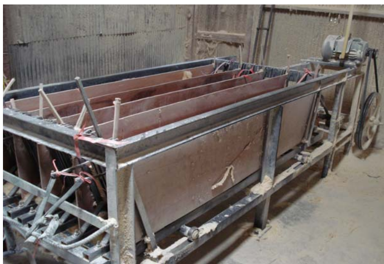
ภาพที่ 6 การนำไม้เส้นที่ผ่านการเหลาปลายไม้แล้วมาเข้าเครื่องขัดอย่างละเอียดอีกครั้งหนึ่ง
