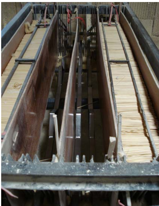
ภาพที่ 4 การนำไม้เส้นมาเข้าเครื่องขัดเพื่อกำจัดเสี้ยนบนผิวของไม้เส้น
