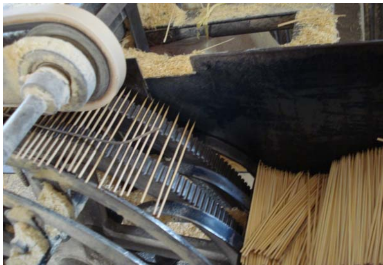
ภาพที่ 5 การนำไม้เส้นที่ผ่านการกำจัดเส้นแล้วมาเข้าเครื่องเหลาปลายไม้ให้แหลม
