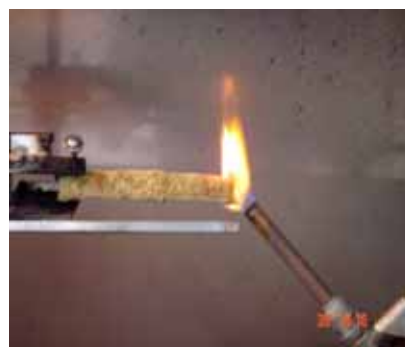
ภาพที่ 32 วิธีการทดสอบหาอัตราการลามไฟของชิ้นงานแผ่นฉนวนทดสอบ
