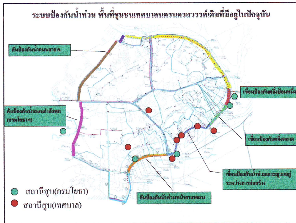
แผนภาพที่ 6 แผนที่แสดงระบบป้องกันน้ำท่วม พื้นที่ชุมชนเทศบาลนครสวรรคร์เดิม
