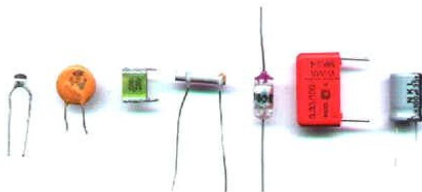
รูปที่ 2.28 แสดงค่าความจุและรหัสตัวเลขที่พิมพ์ติดไว้บริเวณตัวเก็บประจุ
