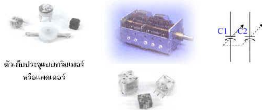
รูปที่ 2.26 แสดงโครงสร้างและสัญลักษณ์ของตัวเก็บประจุแบบปรับค่าได้
