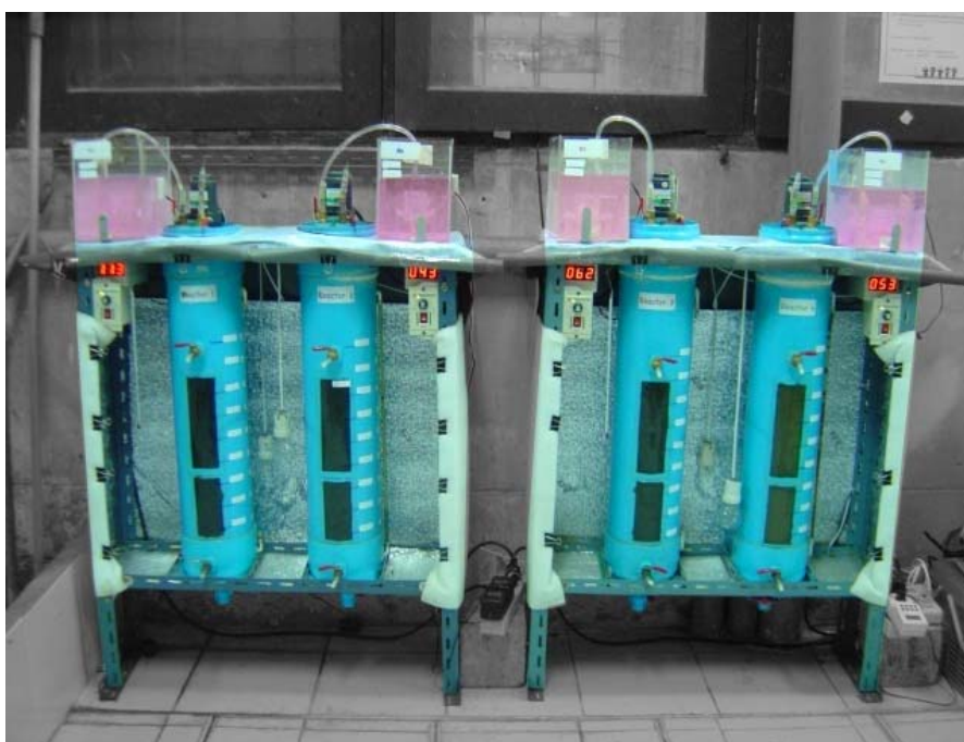
ภาพผนวกที่ ข2 ถึงปฏิกิริยาหลังจากการเสริมฉนวนกันความร้อน
