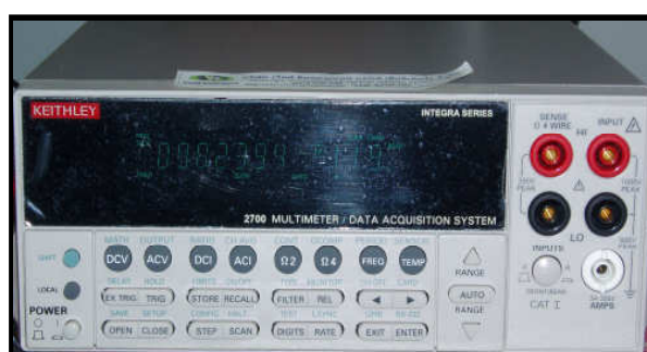
ภาพที่ 16 เครื่องวัดกระแสไฟฟ้า (Multi meter)
