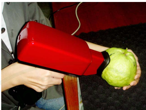
ภาพที่ 22 การวัดสเปกตรัมผลฝรั่งด้วยเครื่อง NIR Spectrometer FQA-NIRGUN
