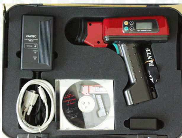
ภาพที่ 21 เครื่องสเปกโตรมิเตอร์แบบพกพา (FQA-NIRGUN, Japan)
