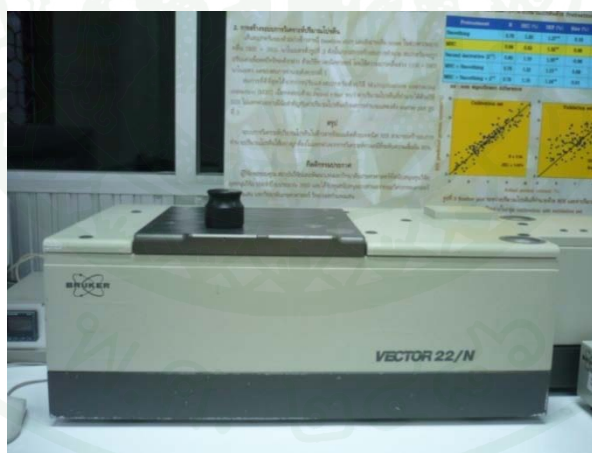
ภาพที่ 23 เครื่อง FT-NIR Spectrometer (Bruker Optics Vector22/N, Germany)
