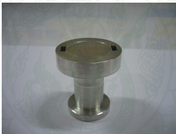
ภาพที่ 50 เซลล์ใส่ตัวอย่างสำหรับวัดสเปกตรัมของน้ำฝรั่งที่สร้างขึ้น
