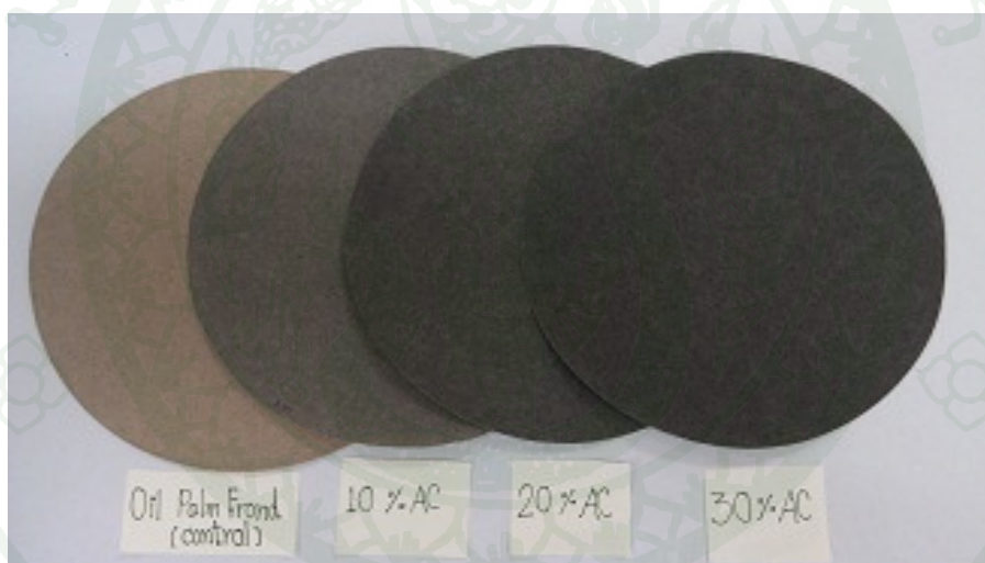
ภาพที่ 39 ตัวอย่างแผ่นดูดซับเอทิลีนจากทางใบปาล์มน้ำมันที่มีปริมาณของผงถ่านกัมมันต์แตกต่างกัน
