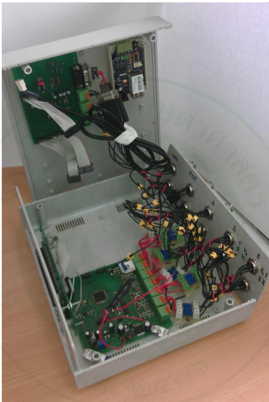
ภาพที่ 28 แผงวงจรต้นแบบของอุปกรณ์ Data Logger
