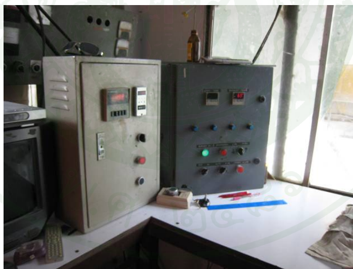
ภาพผนวกที่ ก5 เครื่องมือควบคุมปริมาณหินและยางที่ใช้ในการผสมแบบหน้าจอ Digital
