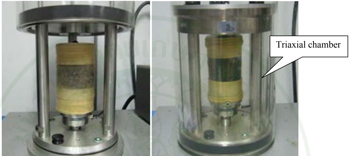
ภาพที่ 63 การติดตั้งก้อนตัวอย่างในการทำ Dynamic Creep Test
