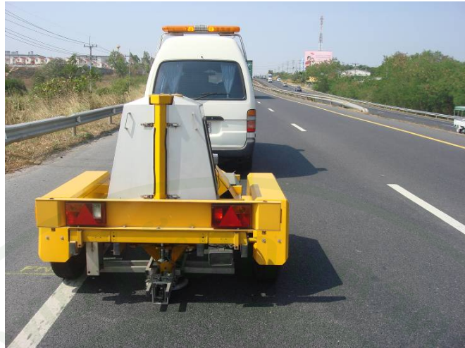
ภาพที่ 70 การทดสอบความแข็งแรงของถนนด้วยเครื่อง FWD
