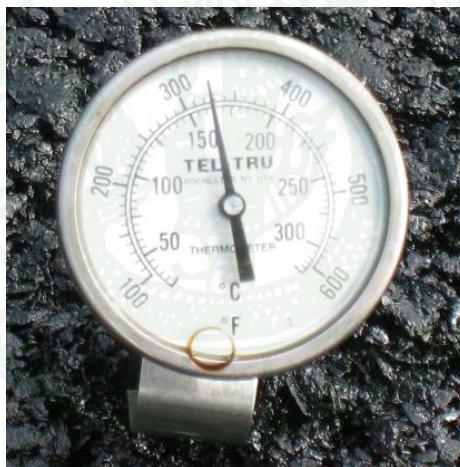
ภาพผนวกที่ ก8 แสดงอุณหภูมิขณะการบดทับชั้นต้น
