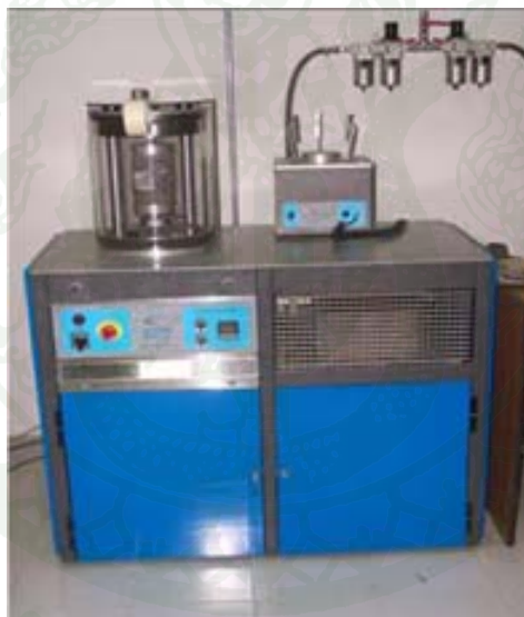
ภาพที่ 41 เครื่องทดสอบ Simple Performance Tester
