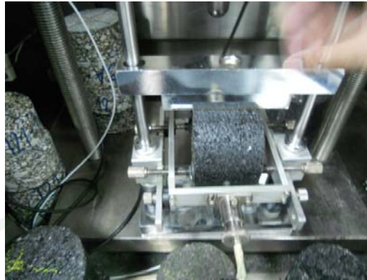
ภาพที่ 52 แสดงการนำแกนเหล็กมาวางด้านบนก่อนตัวอย่าง
