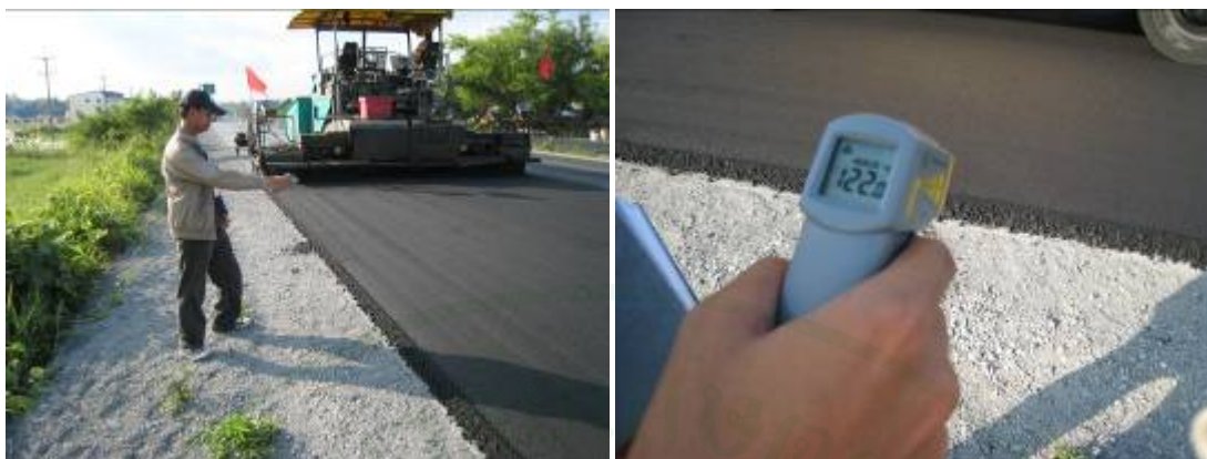
ภาพที่ 69 การใช้เครื่องเลเซอร์วัดอุณหภูมิผิวทางที่อยู่ระหว่างการบดอัด
