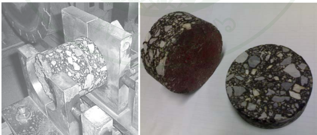
ภาพที่ 49 ก้อนตัวอย่างแอสฟัลต์คอนกรีตขณะติดตั้งกับเครื่องตัดตัวอย่าง
