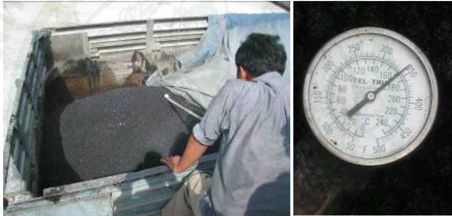
ภาพที่ 67 การวัดอุณหภูมิที่ท้ายรถบรรทุก ณ โรงงานผสม
