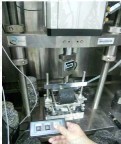
ภาพที่ 52 แสดงการนำแกนเหล็กมาวางด้านบนก่อนตัวอย่าง
