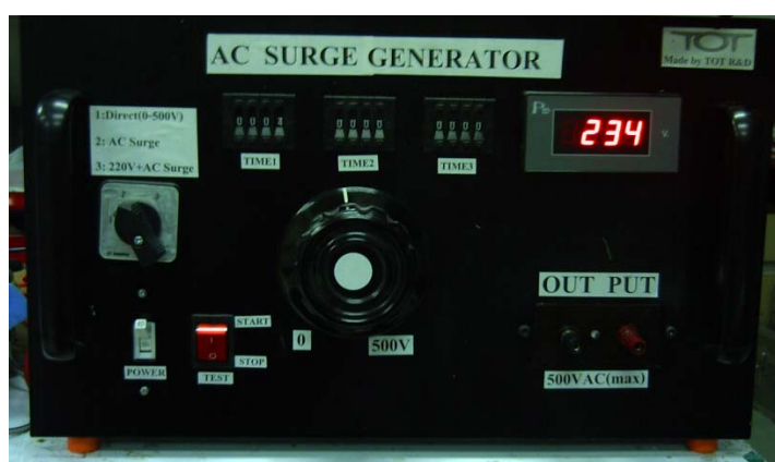
ภาพที่ 53 เครื่อง AC SURGE GENERATOR ที่ใช้ในการทดสอบ
