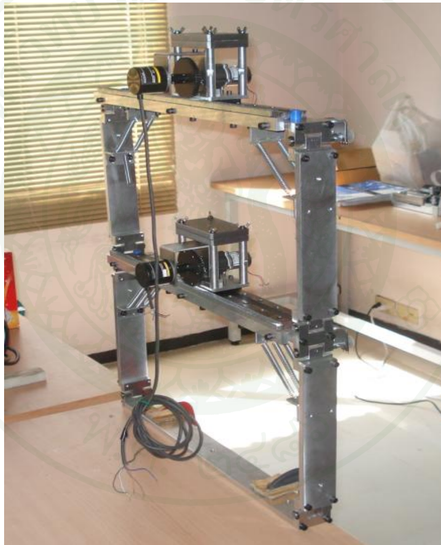
ภาพที่ 12 การยึดโครงสร้างโดยใช้บานพับ
