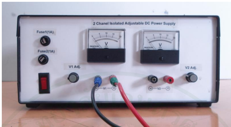
ภาพที่ 15 ตัวจ่ายไฟฟ้ากระแสตรง
