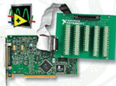
ภาพที่ 17 การ์ดรับส่งข้อมูล (data acquisition) NI PCI 6221 (CB68)
