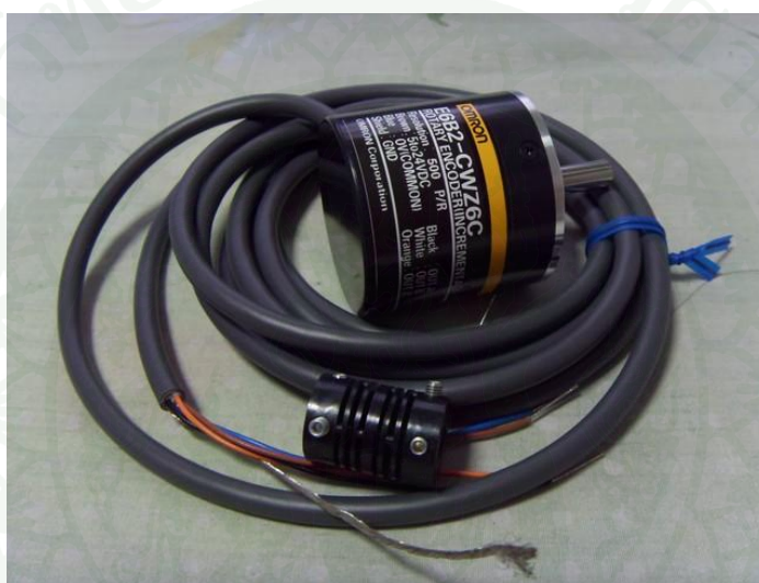
ภาพที่ 9 เอนโคเดอร์ของบริษัท Omron รุ่น E6B2 CWZ6C
