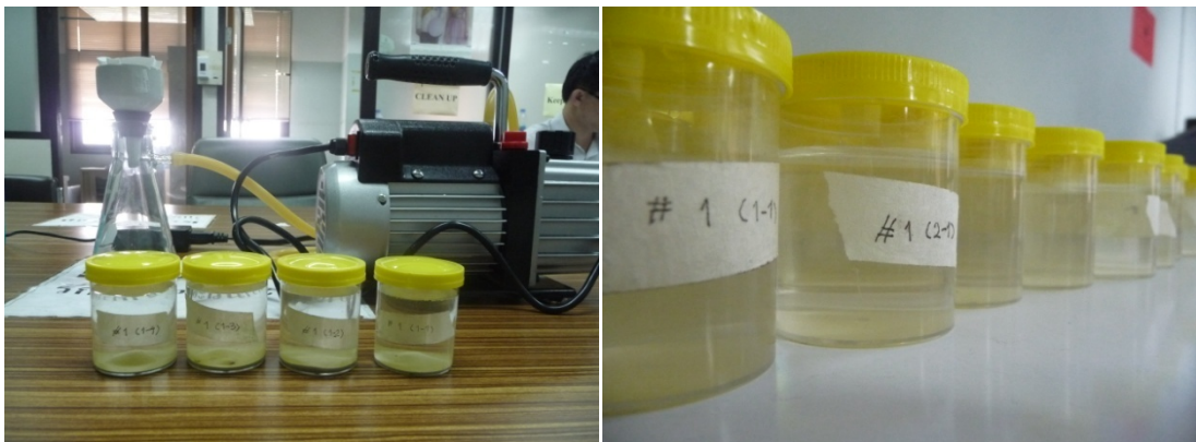
ภาพที่ 19 ตัวอย่างการกรองผงคอนกรีตด้วยเครื่องดูดสุญญากาศและการเตรียมตัวอย่างเพื่อทำการไทเทรต (Titration) หาปริมาณคลอไรด์อิสระ
