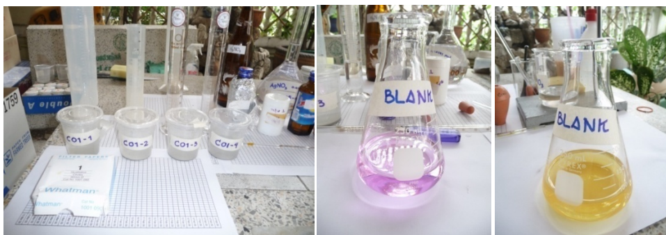
ภาพที่ 17 แสดงการเตรียมตัวอย่างในการทดสอบหาปริมาณคลอไรด์ในผงคอนกรีต, การปรับสภาพความเป็นกรดค่า (pH) และการทำ Blank
