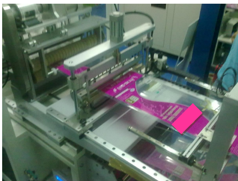
ภาพประกอบ 39 การปิดผนึกปากถุง (ปิดผนึกหลังเครื่อง)
