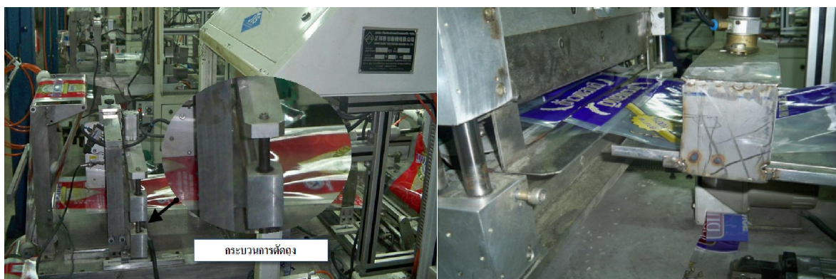
ภาพประกอบ 30 การตัดถุง พิมพ์วันที่ผลิตและปิดผนึกปากถุง (หลังเครื่อง) (เดิม)
