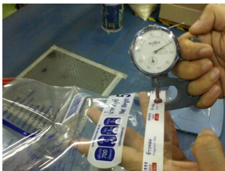
ภาพประกอบ 42 การตรวจสอบความหนาของถุงบรรจุ
