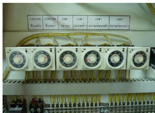
ภาพประกอบ 34 การปรับตั้งค่าสำหรับปิดผนึกกันถุง (เดิม)
