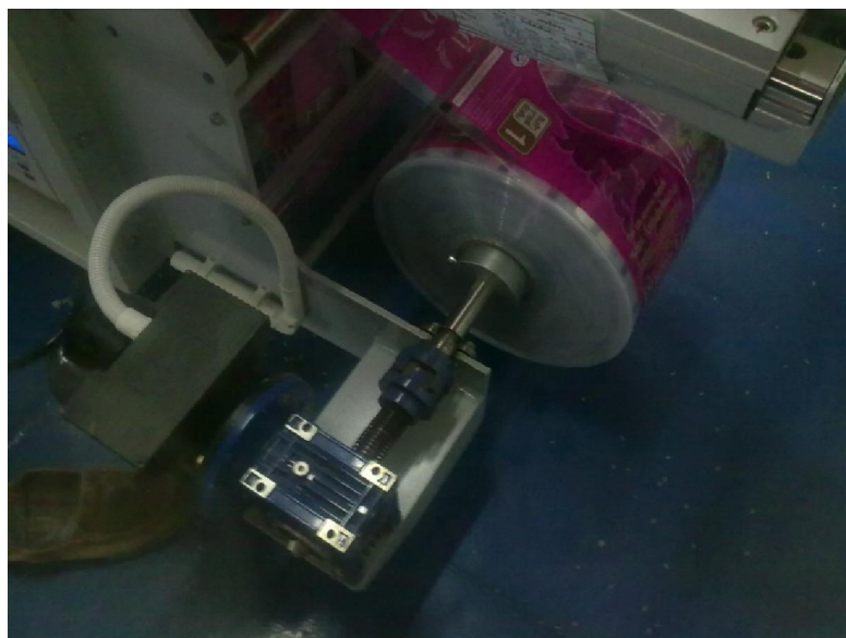
ภาพประกอบ 37 การติดตั้งถุงบรรจุข้าวสาร (เครื่องจักรใหม่)
