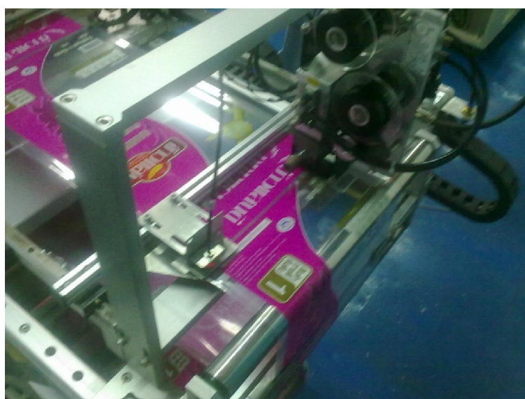
ภาพประกอบ 38 การตัดถุงแยกออกจากกัน
