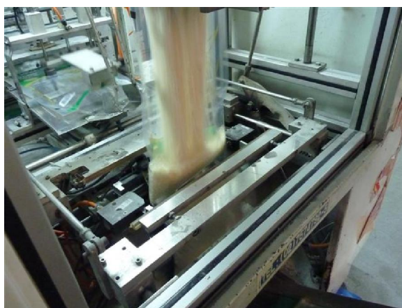
ภาพประกอบ 31 การจับปากถุงและบรรจุข้างลงถุง (เดิม)
