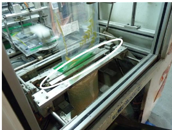
ภาพประกอบ 32 การปิดผนึกกันถุง (หน้าเครื่อง) (เดิม)
