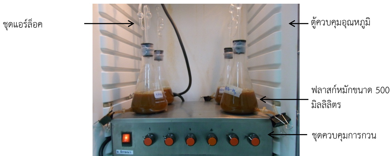
รูปที่ 3.1 การผลิตเอทานอลแบบกะในพลาสติกแอร์ล็อกขนาด 500 มิลลิลิตร
