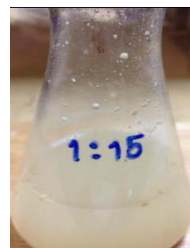
4. เติมนกรด HCl ที่อัตราส่วนต่างๆ และนำไปต้มในหม้อนึ่งความดันไอ 121C, 20นาที
