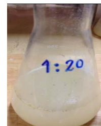
4. เติมนกรด HCl ที่อัตราส่วนต่างๆ และนำไปต้มในหม้อนึ่งความดันไอ 121C, 20นาที
