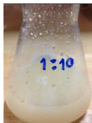
4. เติมนกรด HCl ที่อัตราส่วนต่างๆ และนำไปต้มในหม้อนึ่งความดันไอ 121C, 20นาที
