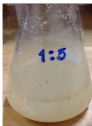
4. เติมนกรด HCl ที่อัตราส่วนต่างๆ และนำไปต้มในหม้อนึ่งความดันไอ 121C, 20นาที
