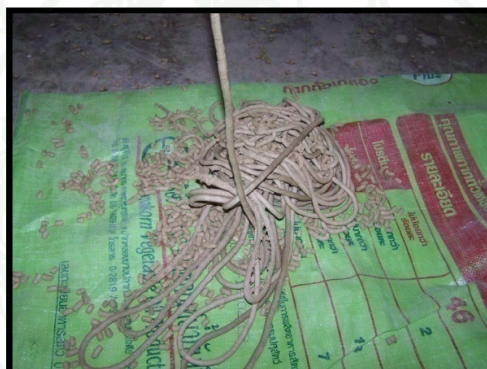
ภาพผนวกที่ ข 4 เมื่อเข้ากันแล้วจากนั้นเปิดสวิตช์ควบคุมการไหลของวัตถุดิบไปยังท่อกระบอกลอยหะจนอาหารออกจากท่อกระบอกลอยออกมามีลักษณะเป็นของหนืดเป็นเส้น
