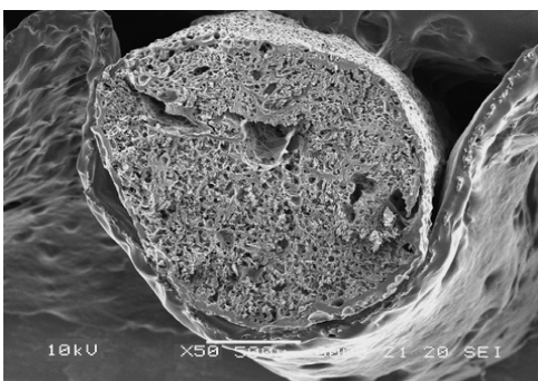
ภาพที่ 29 โครงสร้างขนมจีนแป้งหมักปกติ (สูตรที่ 1) และขนมจีนแป้งหมักผสมกับร้อยละ 0.3 คือ แซนแทน (สูตรที่ 8) และกัมซีเอ็มซี (สูตรที่ 11) และกัมกัวร์ (สูตรที่ 14) กำลังขยาย 50 เท่า ก่อนการแช่เยือกแข็ง และการคืนรูปจากเยือกแข็งแบบอากาศเย็นจัดรอบที่ 5
