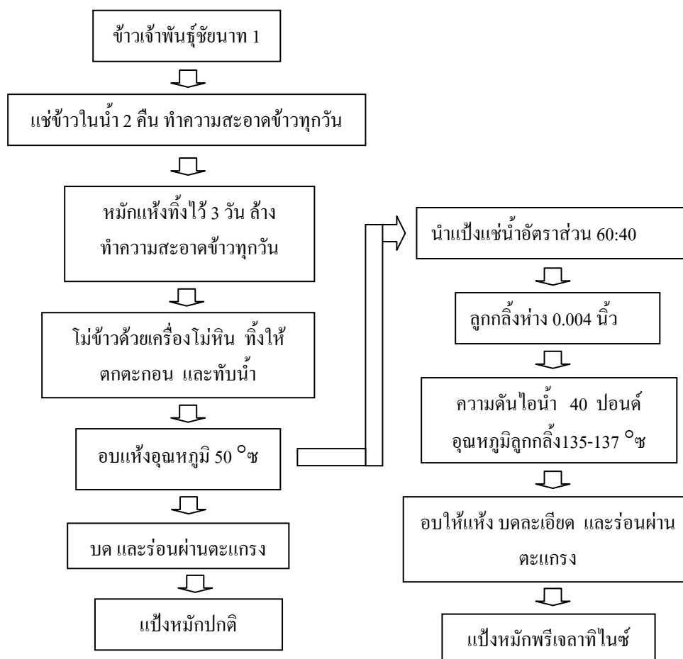
ภาพที่ 16 กระบวนการผลิตแป้งหมักปกติ และแป้งหมักพรีเจลาทีไนซ์ ที่มา: ภควัฒน์ (2547)
