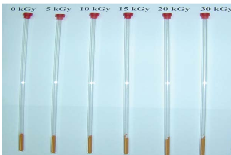
ภาพที่ 6 แสดงหลอดแก้วควอตซ์บรรจุพริกเพื่อเตรียมวัดปริมาณอนุมูลอิสระ โดยเครื่องอิเล็กทรอนิกส์สปินเรโซแนนซ์
