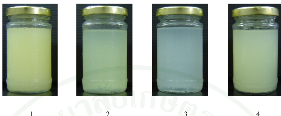
ภาพที่ 17 ตัวอย่างน้ำมะนาวก่อนและหลังผ่านเรซินสังเคราะห์
