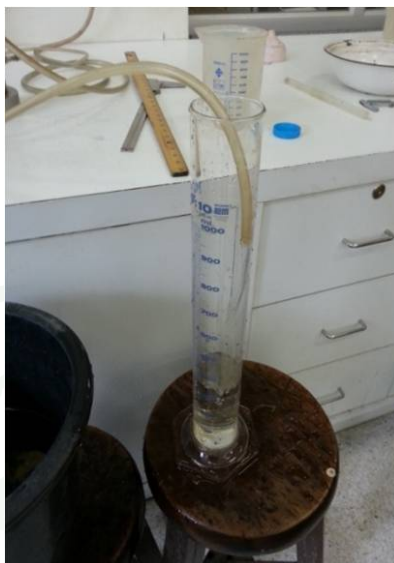
ภาพผนวกที่ ข4 การวัดอัตราการไหลของน้ำที่ไหลซึมผ่านเมมเบรน
