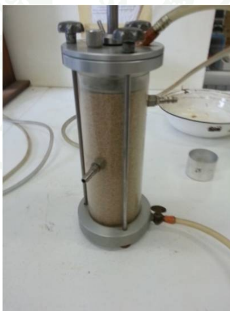
ภาพผนวกที่ ข2 การติดตั้งโมลในการทดสอบค่าความชื้นน้ำ
