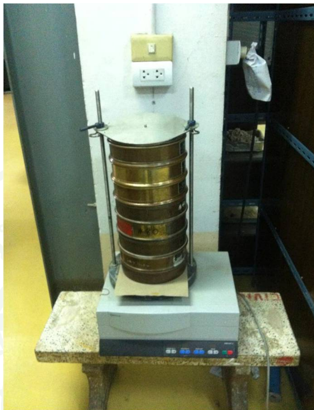
ภาพผนวกที่ ก2 เครื่องเขย่าตะแกรงที่ใช้ในการทดสอบ
