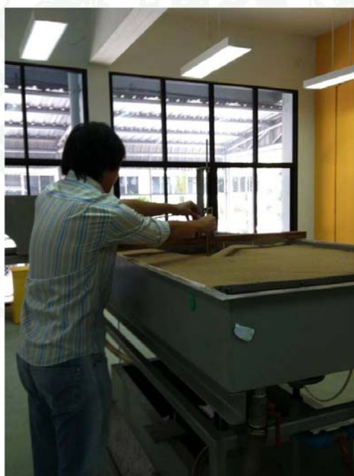
ภาพผนวกที่ ค2 การวัดความลึกร่องน้ำโดยใช้เวอร์เนียแบบสเกล
