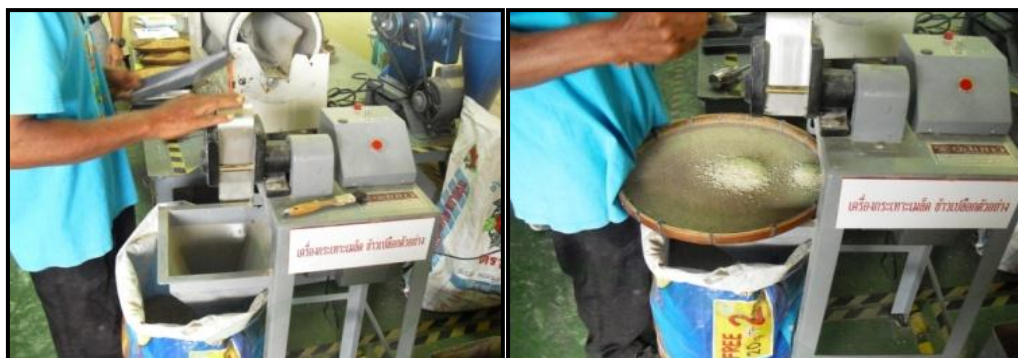
ภาพที่ 21 การสีข้าวในเครื่องกะเทาะเปลือกและเครื่องสีข้าว
