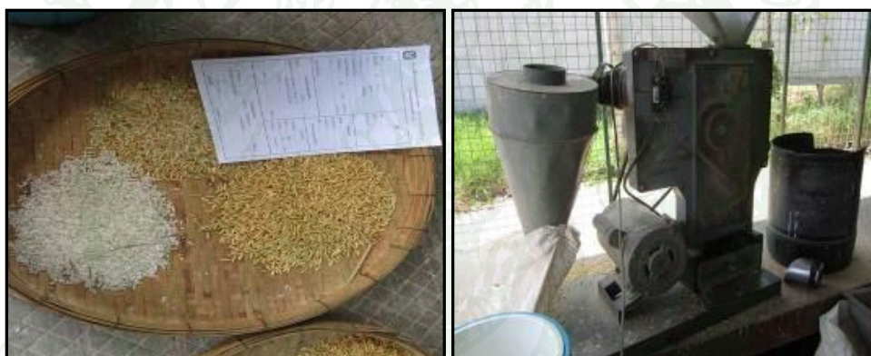
ภาพที่ 31 ถาดข้าวที่จะตรวจสอบคุณภาพ (ซ้าย) เครื่องสีข้าว (ขวา)
