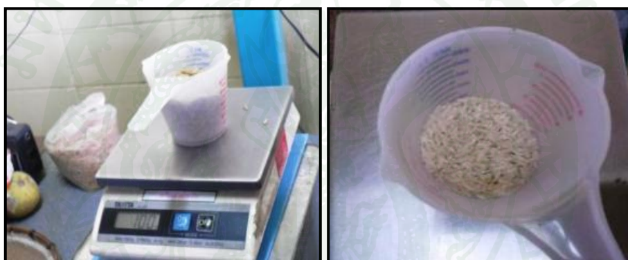
ภาพที่ 22 การชั่งน้ำหนักเพื่อตรวจสอบสัดส่วนของฟ่อน ต้นข้าว ข้าวกล้อง และความแตกหัก (ร้อยละ)
