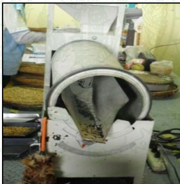
ภาพที่ 20 เครื่องกะเทาะเปลือกและเครื่องสีข้าว
