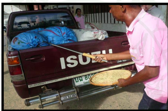
ภาพที่ 37 การสุ่มตัวอย่างบนรถกระบะ
