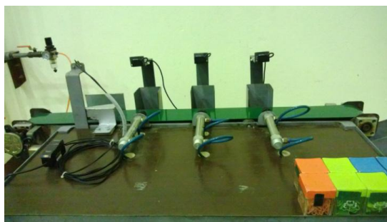
ภาพที่ 3.2 ภาพแบบของสายพานลำเลียงที่ได้สร้างขึ้นมา
