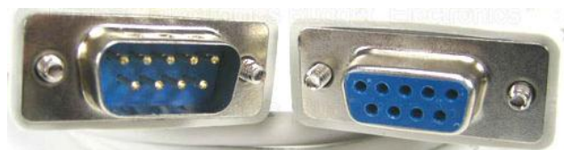
รูปที่ 2.8 DB9 ด้านซ้ายคือตัวผู้ (Male) ส่วนด้านขวาคือตัวเมีย (Female) [10]
