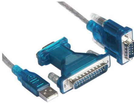
รูปที่ 2.7 พอร์ตอนุกรม RS-232 เพื่อเชื่อมต่อกับพอร์ต USB [9]
