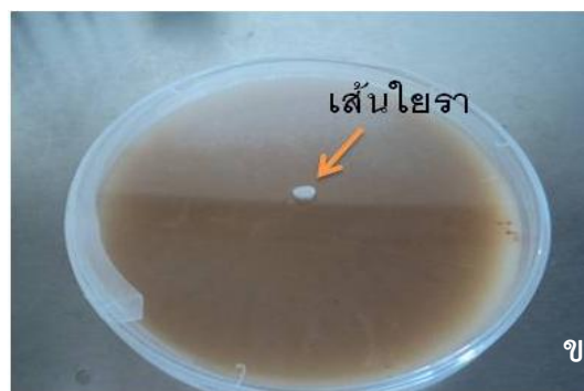
ภาพที่ 4 แสดงการใช้ cork borer เจาะเส้นใยรา (ก.) และนำไปวางบนอาหารเลี้ยงเชื้อที่ทำการทดสอบ (ข.)
