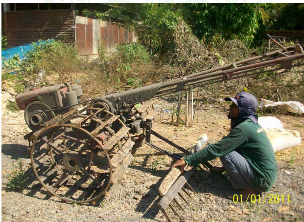
ภาพผนวกที่ ค4 รถไถนาขนาดเล็กแบบเดินตามใช้สำหรับการเตรียมดินในแปลงนาข้าว
