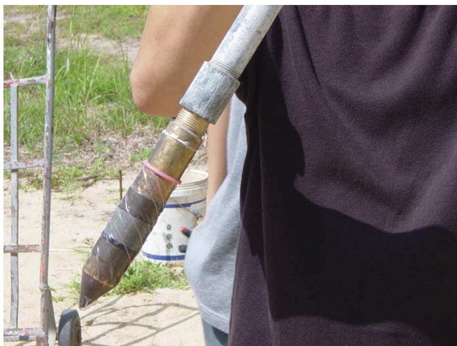
ภาพที่ 66 การควบคุมหินพรุนให้อิ่มตัวตลอดเวลาโดยใช้ถุงยางป้องกัน KU Piezometer
