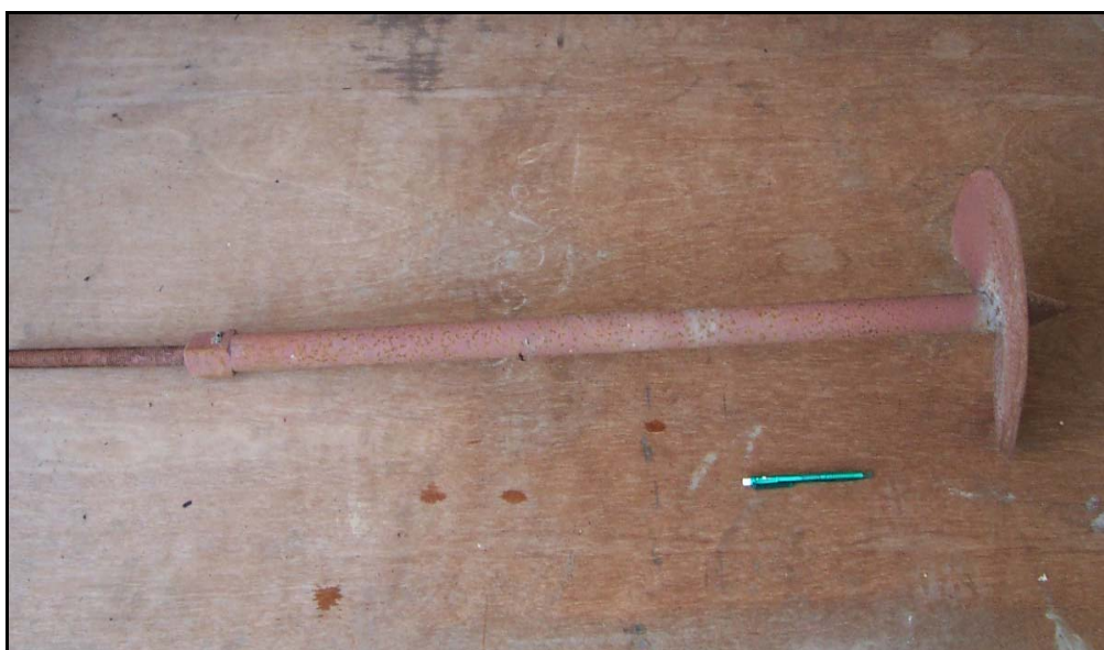
ภาพที่ 47 อุปกรณ์วัดการทรุดตัวที่ผิวดิน (Surface Settlement Plate)
