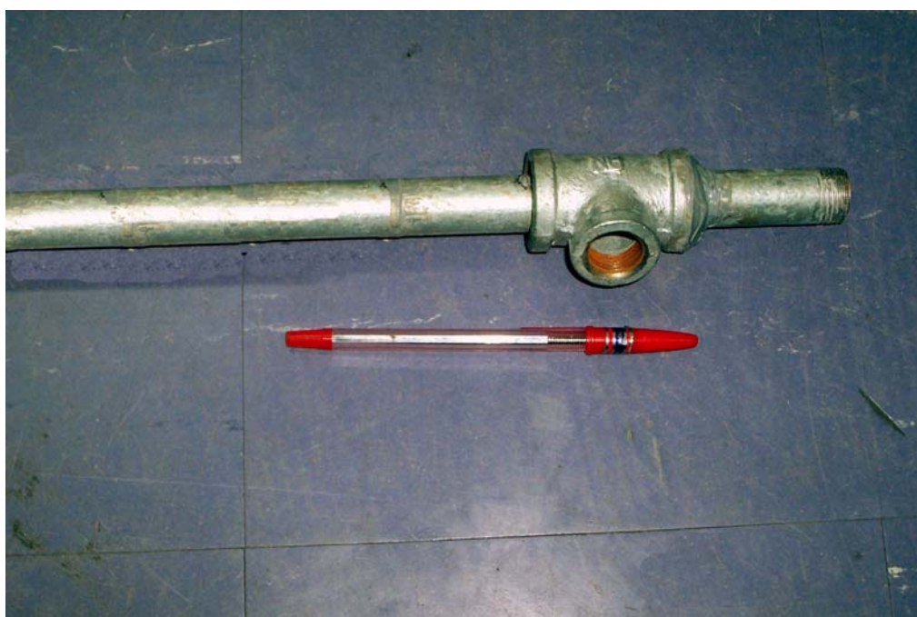
ภาพที่ 43 ท่อเหล็กภายในท่อทองแดงขนาดเส้นผ่าศูนย์กลาง ½ นิ้ว
