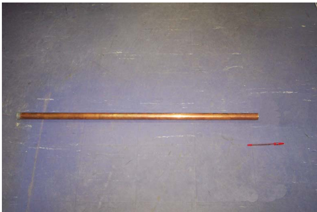
ภาพที่ 42 ท่อทองแดงสำหรับส่งผ่านน้ำร้อนขนาดเส้นผ่าศูนย์กลาง 1 นิ้ว
