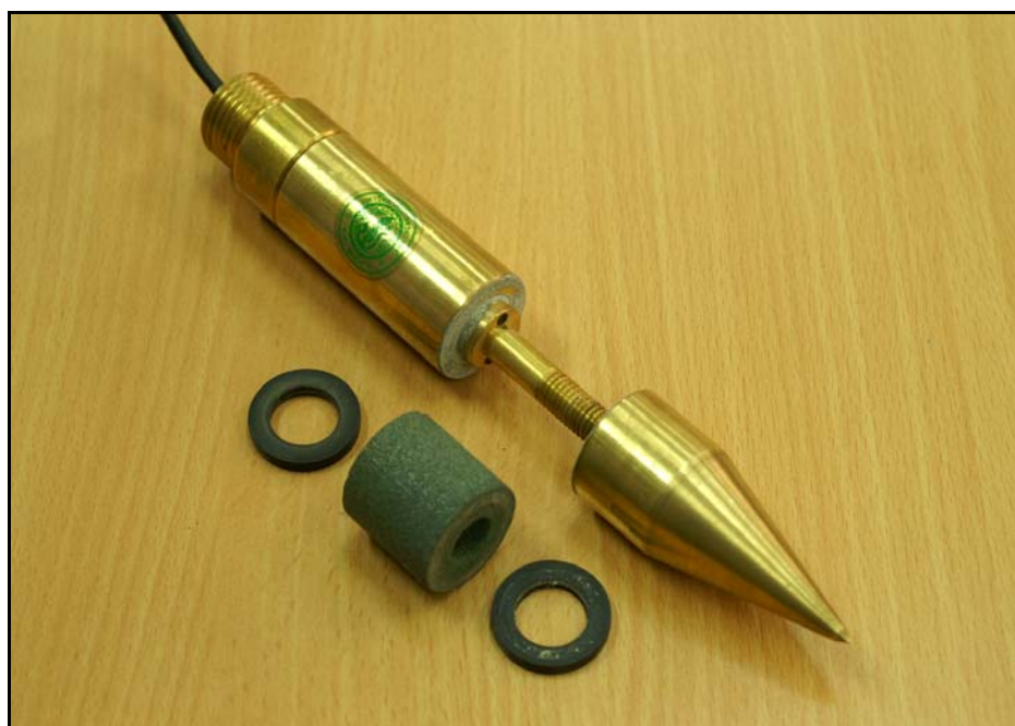
ภาพที่ 49 ส่วนประกอบอุปกรณ์วัดแรงดันน้ำด้วยระบบไฟฟ้าแบบเกษตรศาสตร์ (KU Piezometer)
