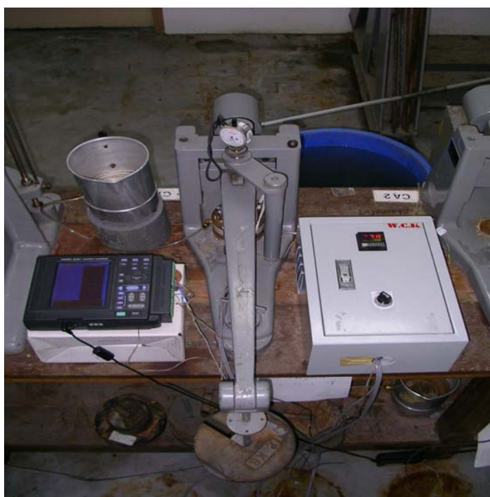
ภาพที่ 34 อุปกรณ์การทดสอบหาค่าการนำพาความร้อนแบบการอัดตัวคายน้ำ
