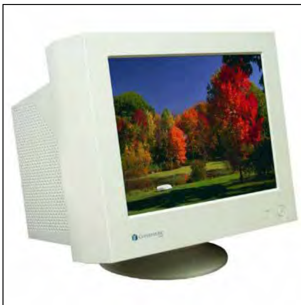
ภาพที่ 15 จอแสดงผลแบบหลอดภาพ CRT
