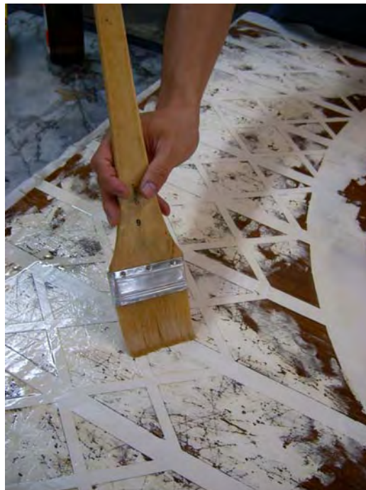
ภาพที่ 24 ภาพการทำแลคเกอร์เคลือบผิวแม่พิมพ์เพื่อให้แม่พิมพ์คงทน
