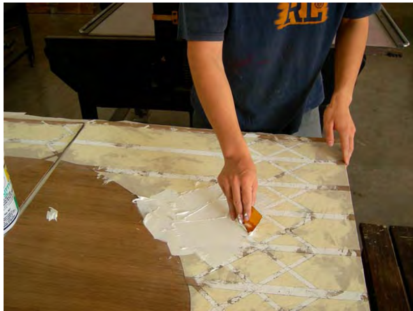
ภาพที่ 22 ภาพการสร้างพื้นผิวบนแม่พิมพ์เพื่อให้เกิดร่อง
