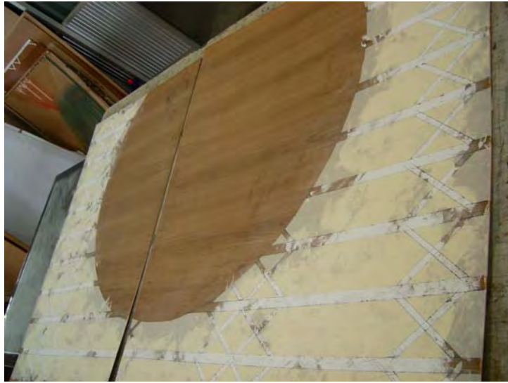
ภาพที่ 21 ภาพการสร้างพื้นผิวบนแม่พิมพ์เพื่อให้เกิดร่อง
