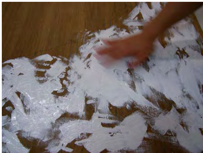
ภาพที่ 19 ภาพการทำ putty เพื่อสร้างพื้นผิวบนแม่พิมพ์
