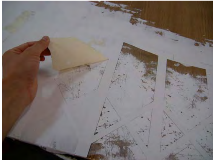
ภาพที่ 23 ภาพการสร้างพื้นผิวบนแม่พิมพ์เพื่อให้เกิดร่อง
