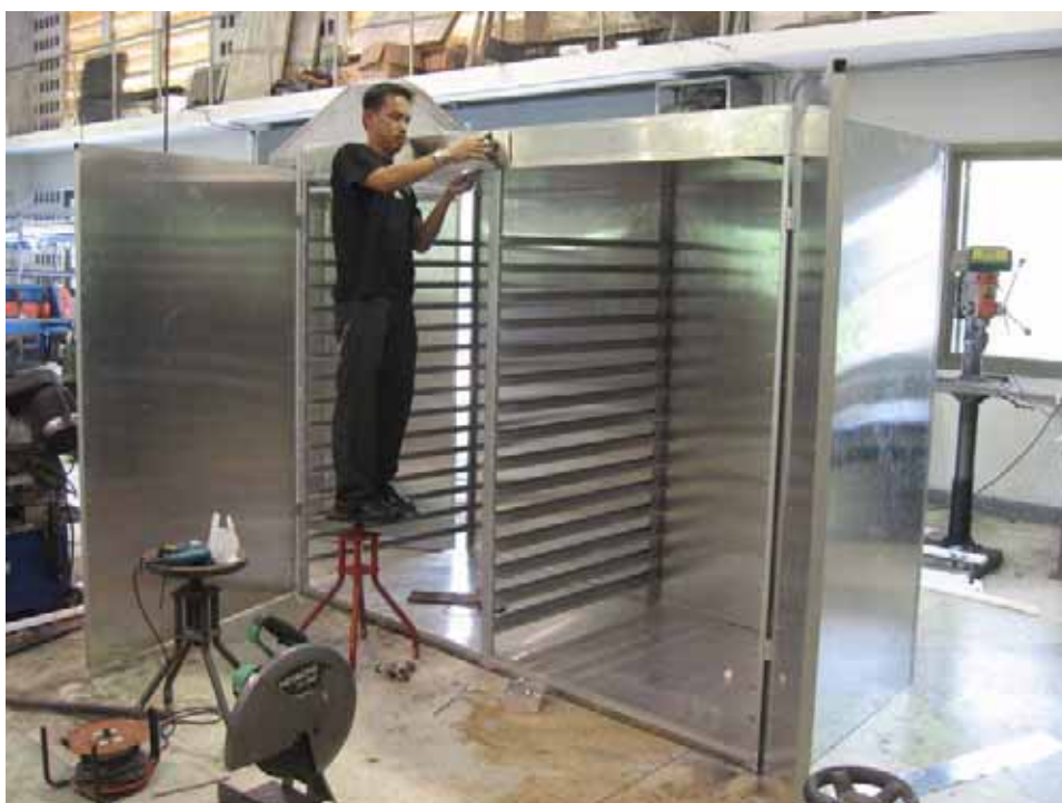
รูปที่ A1.5 แสดงการสร้างโครงสร้างของตู้อบอบแห้งแบบถาด
