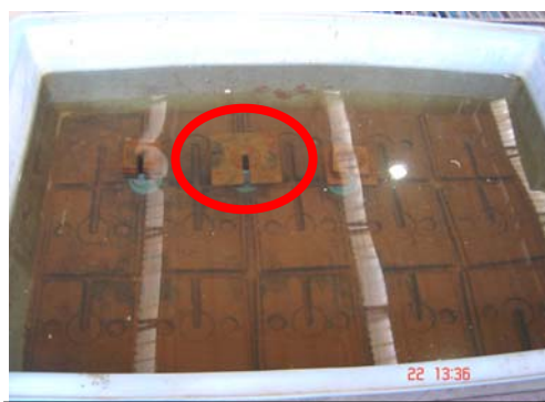
ข. นำตัวอย่างไปแช่น้ำโดยให้น้ำท่วม
