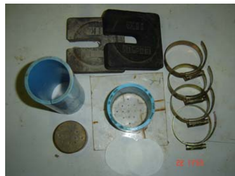
ภาพที่ 32 อุปกรณ์เตรียมตัวอย่างทดสอบ Unconfined Compression Test และอุปกรณ์การแช่ตัวอย่างในน้ำ
