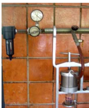
ข. ใช้แรงดันบีบ ารละลายในดินออกมา
