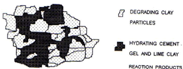
ภาพที่ 12 ลักษณะโครงสร้างดินซีเมนต์ภายใต้การบ่มระยะสั้น
