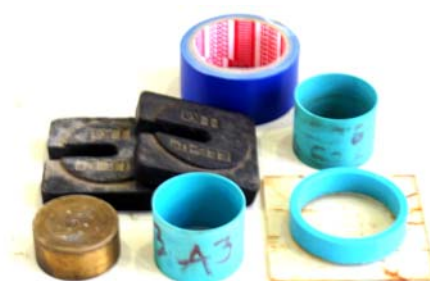
ภาพที่ 33 อุปกรณ์เตรียมตัวอย่างทดสอบ Direct Shear Test และอุปกรณ์การแช่ตัวอย่างในน้ำ
