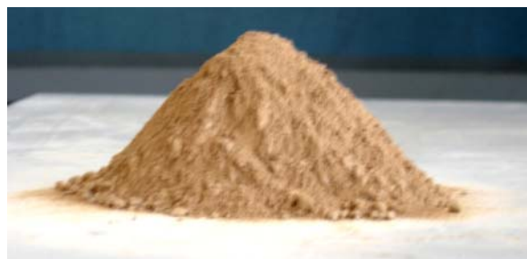
ภาพที่ 29 ดินที่ใช้ในการศึกษาวิจัยที่ต้องร่อนผ่านตะแกรงเบอร์ 4
