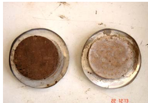
ข. ดันตัวอย่างออก ชั่งน้ำหนัก ก่อนอบ-หลัง
