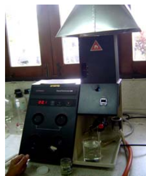
ง. การวัดค่า Na และ K ในดิน จากสารละลาย
