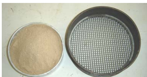
ภาพที่ 29 ดินที่ใช้ในการศึกษาวิจัยที่ต้องร่อนผ่านตะแกรงเบอร์ 4
