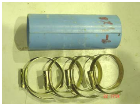
ภาพที่ 32 อุปกรณ์เตรียมตัวอย่างทดสอบ Unconfined Compression Test และอุปกรณ์การแช่ตัวอย่างในน้ำ
