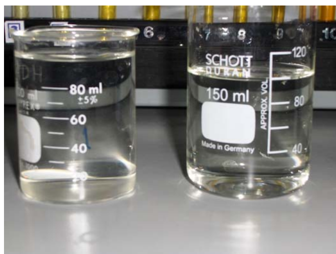
ภาพที่ 16 แสดงประสิทธิภาพการบำบัดน้ำเสียโดยฟenantรีนออกซิเดชัน เมื่อนำไปกรองด้วย 0.45 \mu\text{m}
